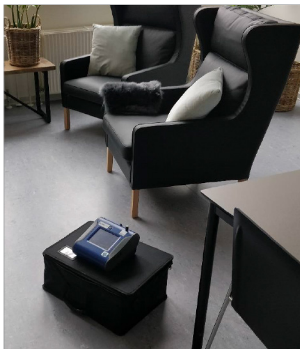
Støvmålinger med sensorer – før og efter tilsætning af støvbinderen – dokumenterer støvreduktionerne. Foto: Aks2tal
